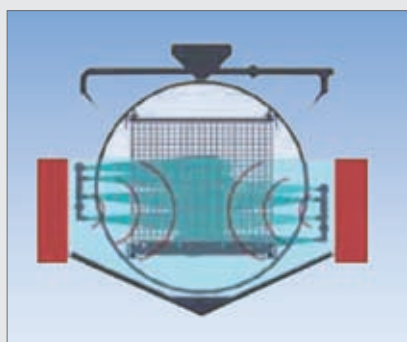
Kombination aus Spritzreinigung und Ultraschall
