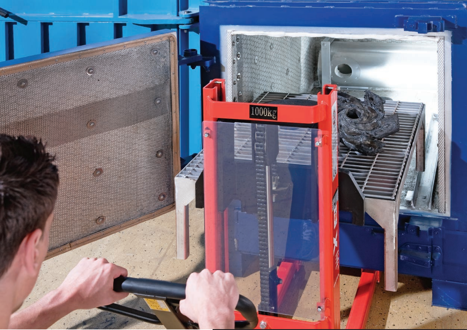
Schnelle Ofenbeschickung mit Hochhubwagen oder Gabelstapler
